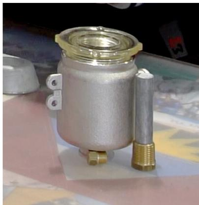
► Sopra un a parte in metallo di una barca che non è stato protetto con un anodo sacrificale e che le correnti galvaniche hanno corrosato sino a renderlo irriconoscibile. Di lato un cestello del filtro dell'acqua di un motore. Il cestello è in ghisa e soggetto alle correnti, al suo interno andrebbe sempre messo un anodo. Sotto, un anodo sacrificale a candela. Questo, montato su di un tappo a ghiera va inserito nello scambiatore di calore
