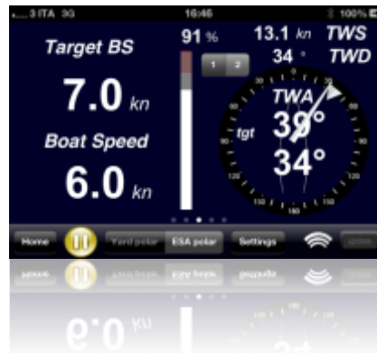
2. Indicazione dei target: angolo al vento e velocità barca per la VMG (bolina e poppa)
