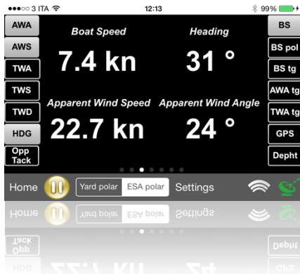
1. Visualizzazione di dati di navigazione, si possono selezionare 4 dati alla volta.
