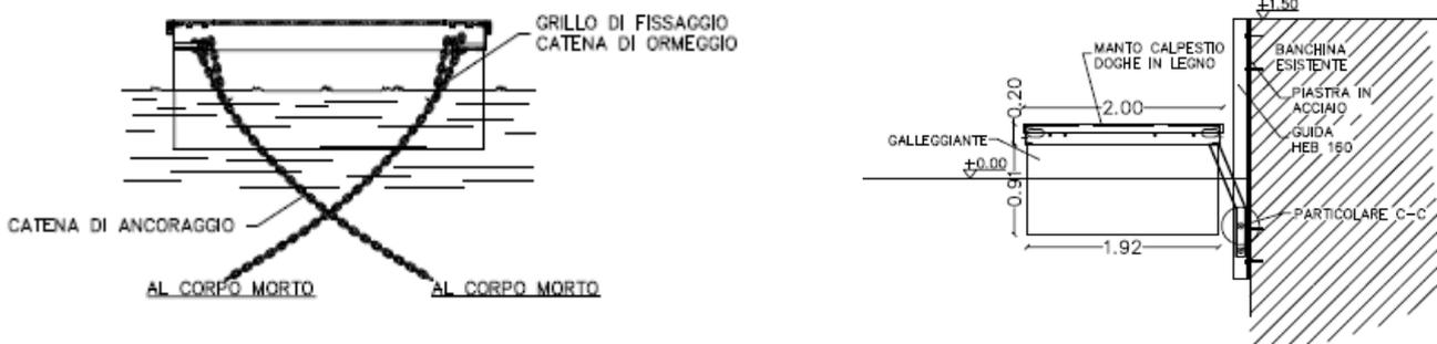
Un terzo pontile di 56 metri di lunghezza e 1,70mt di larghezza è posto lungo la banchina sud e vincolato a essa attraverso un sistema meccanico di scorrimento su guide d'acciaio che ne garantisce l'adattabilità al livello del mare.
